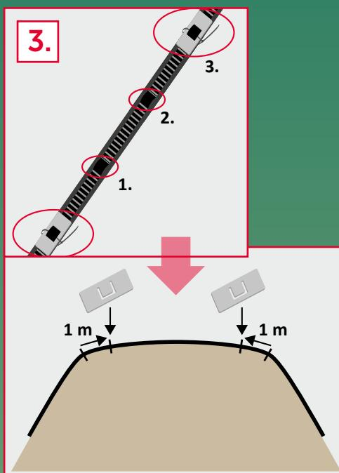
protec® Safeline so über das Silo legen, dass bei der Verwendung eines 120 cm Silosacks ein Abstand von ca. 150 cm zum Boden entsteht. protec® Safeline auf das ermittelte Maß kürzen und die Enden (mit einem Feuerzeug) verschweißen.
