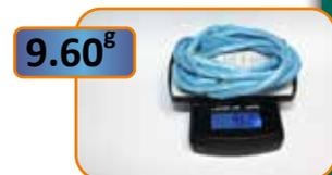
Wiegen Sie die Garnprobe(n) und errechnen Sie mithilfe der folgenden Formel die Reallauflänge der Garne:
