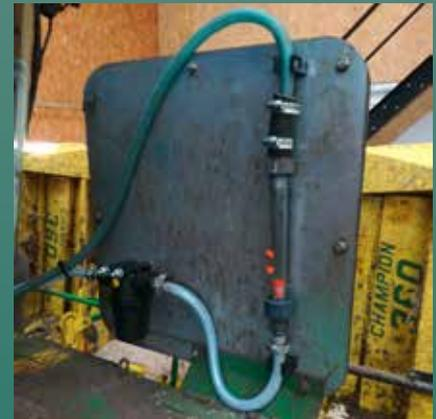
angeschlossener Leitungsfiler und Durchflussmengenmesser
