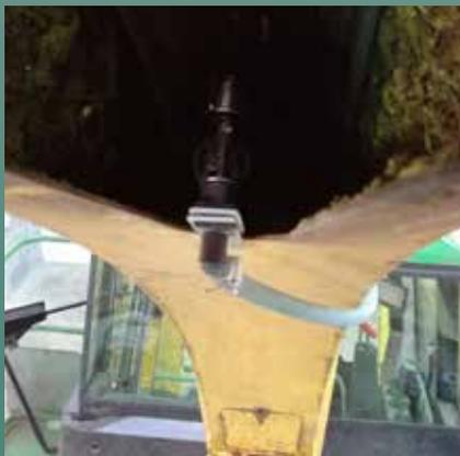
am Turm montierter Düsenträger
