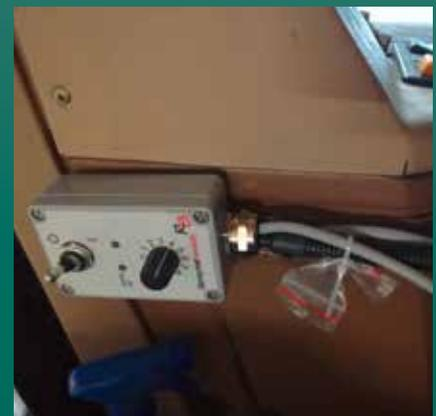
mit Magnet in der Fahrerkabine montierte Steuereinheit
